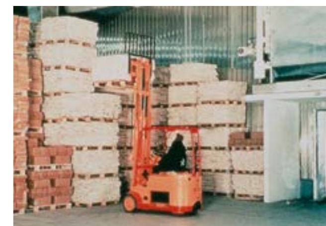
Fig. 14: I carrelli elevatori, le merci stoccate e le scaffalature producono sollecitazioni a carico dei pavimenti del deposito frigorifero isolato termicamente.
