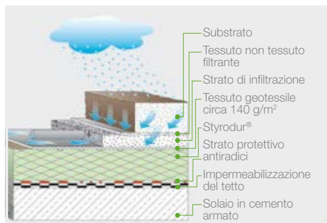
Fig. 30: Disposizione degli strati di un tetto rovescio verde con strato drenante per l'assorbimento superficiale dell'acqua e in alternativa con tubo drenante.
